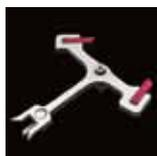
**Ancre** | Organe, en acier ou en laiton, composant l'échappement d'une montre ou d'une pendule. L'ancre, dont la forme rappelle celle d'une ancre de marine, a un double rôle : d'une part transmettre la force du ressort par l'intermédiaire du rouage au balancier afin de faire perdurer les oscillations et, d'autre part, empêcher le déroulement incontrôlé du rouage remonté.
